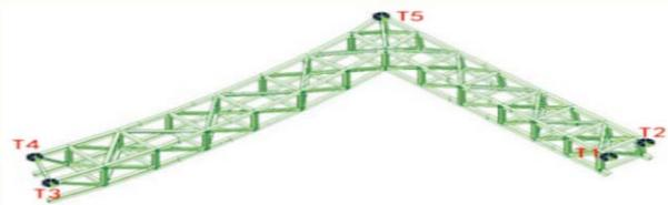
图3悬挑钢桁架提升点
