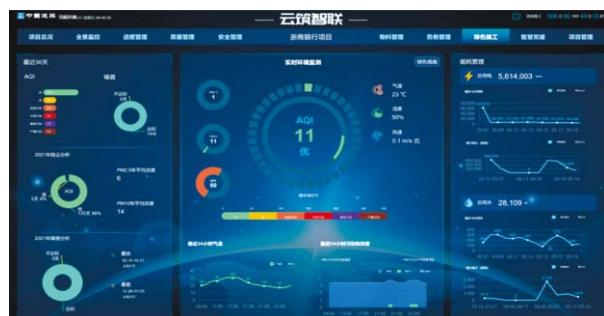
“PM2.5、PM10、扬尘、噪音、用电、用水等，这些现场数据都能看得一清二楚。通过云筑智联平台的电子屏幕，我们可以实时查看现场环境监测及能耗监测数据。”项目经理李少华表示，“项目根据工程实际用量，分为施工现场、项目部以及生活区三个区域，每日监控水电的用量和损耗，每周对异常数据进行排查，从源头控制资源的输出，节水节电，减少碳含量排放。”
