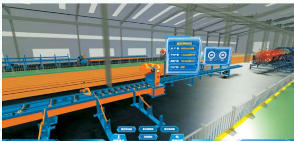
数据液压式智能钢筋剪切线
