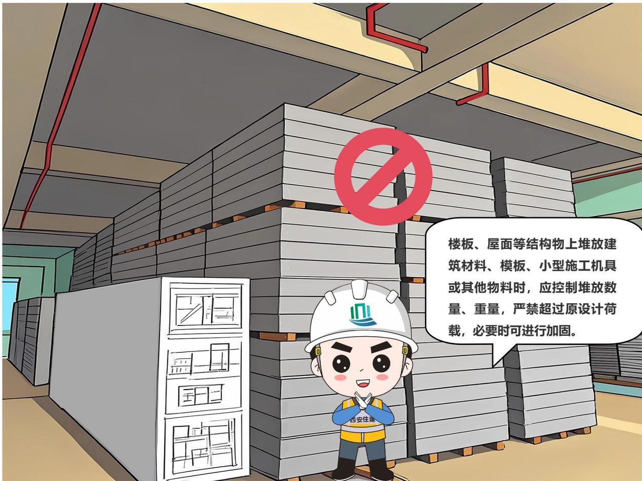
（三）楼板、屋面和地下室顶板等结构构件或脚手架上堆载超过设计允许值。
