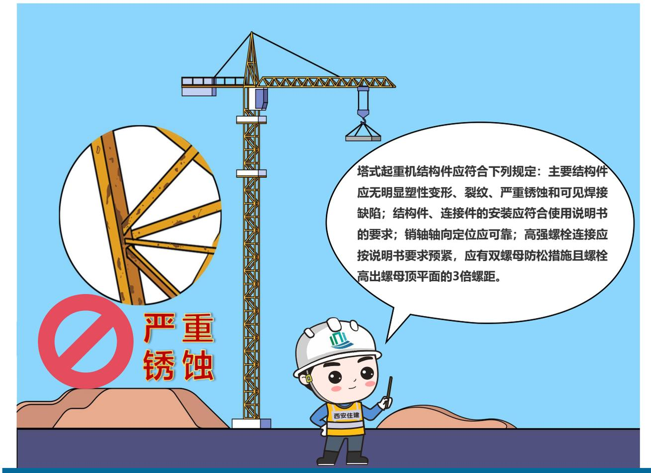
（五）建筑起重机械主要受力构件有可见裂纹、严重锈蚀、塑性变形、开焊，或其连接螺栓、销轴缺失或失效；
