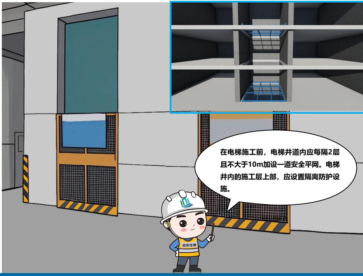
（四）脚手架与结构外表面之间贯通未采取水平防护措施，或电梯井道内贯通未采取水平防护措施且电梯井口未设置防护门；
