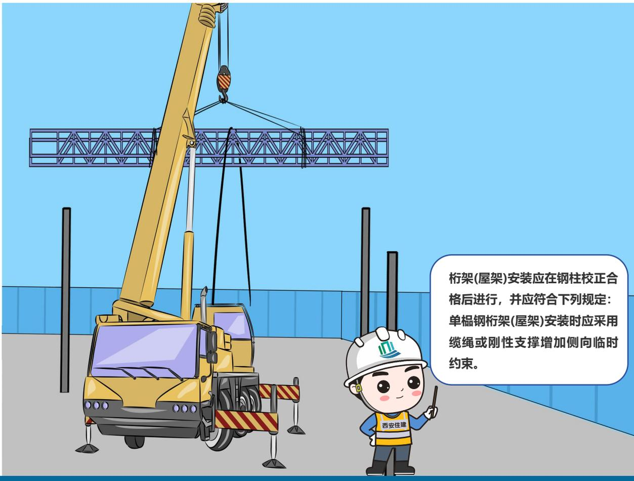
(二) 单榀钢桁架(屋架)等预制构件安装时未采取防失稳措施；
