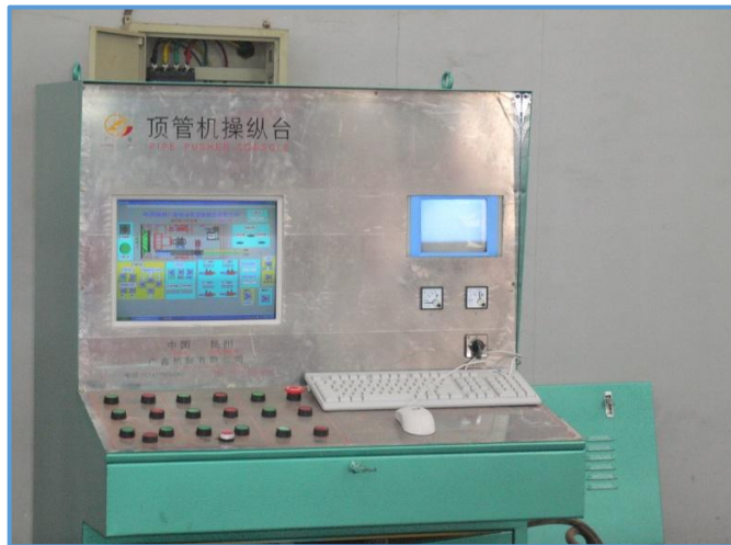
图8-43 可视化顶管机操作
