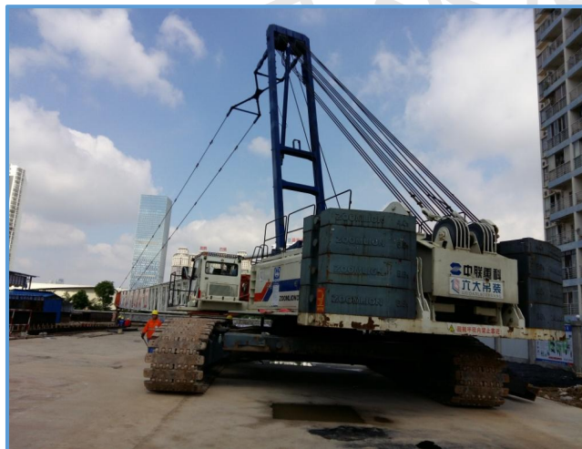
图6-136 履带吊配重块符合要求
