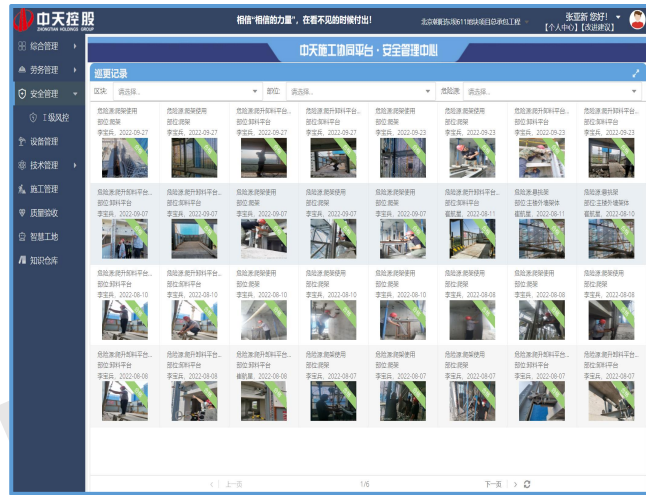
图9-5 安全巡检模块应用（PC端）
