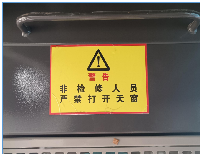
图6-77 施工升降机天窗警示牌
