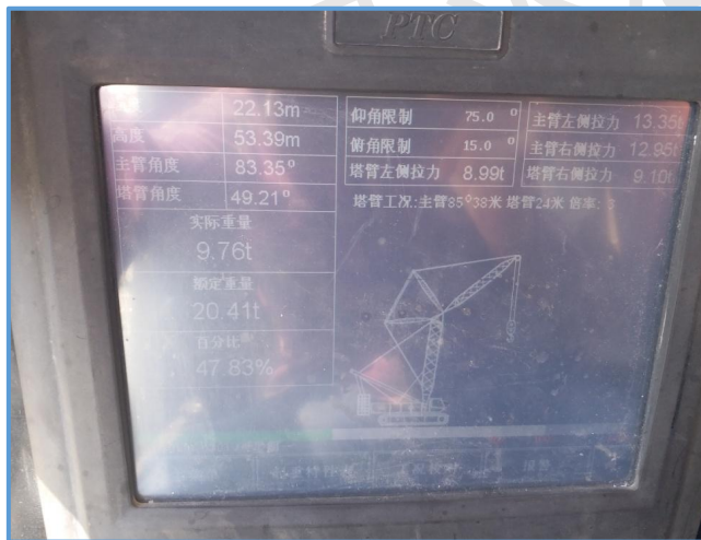
图6-144 履带吊显示器显示数据与实际相符
