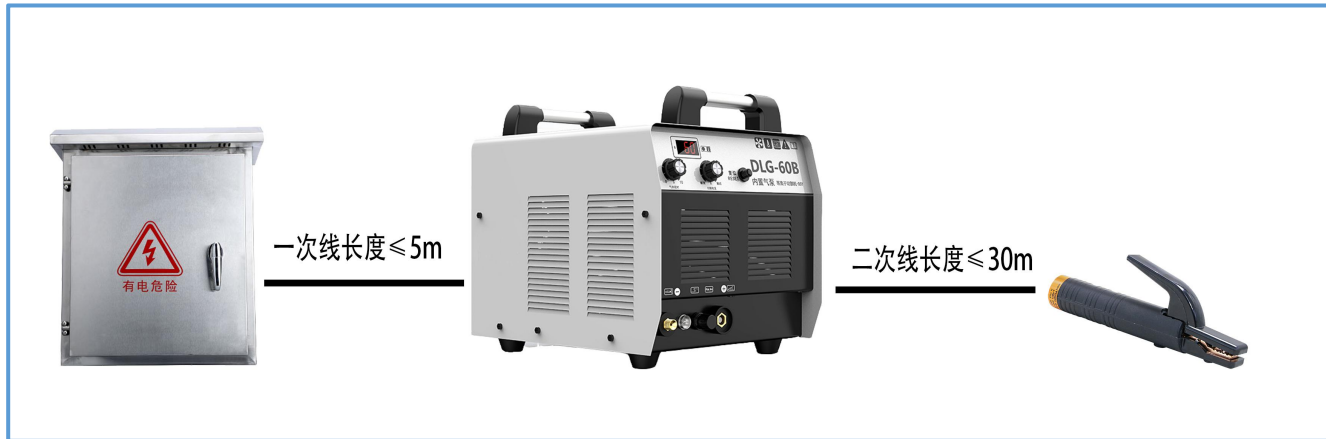
图5-38 电焊机接线
