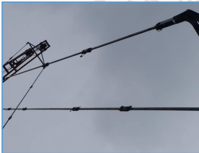
图6-140 履带吊拉板连接销安装保险销
