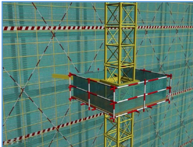
图6-13 塔吊附墙操作平台（方案A）
