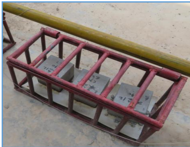
图8-72 混凝土同条件试块强度检测
