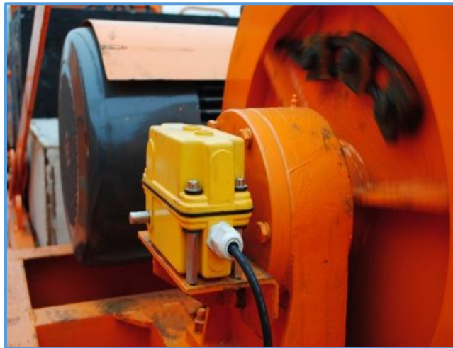
图6-21 塔吊起升高度限位器
