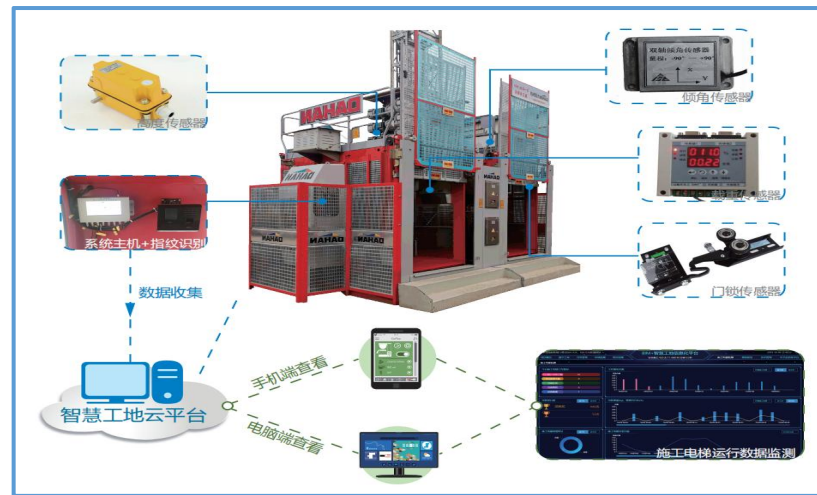
图9-53 施工电梯安全监测系统图
