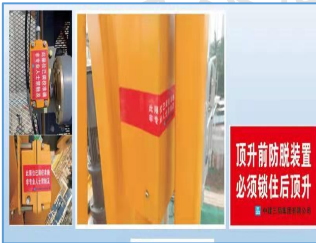
图6-63 塔吊限位警示标志
