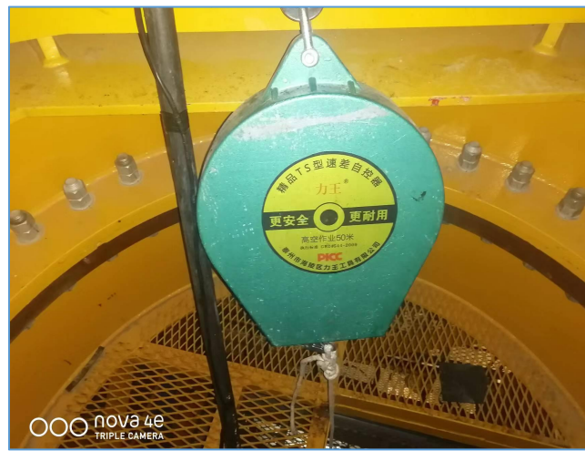
图6-20 塔司上塔防坠安全器
