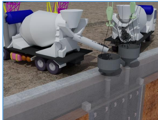
图2-15 地下连续墙浇筑
