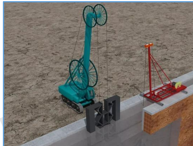
图2-13 地下连续墙成槽
