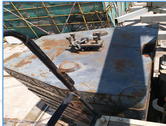
图6-135 履带吊油缸固定销卡板安装有效
