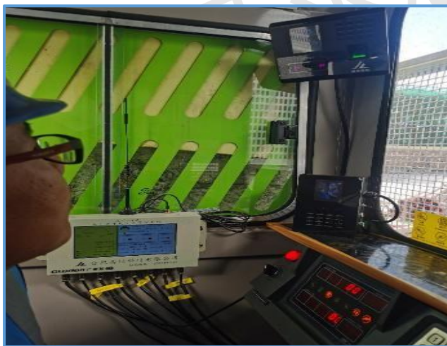
图6-95 施工升降机人脸识别装置
