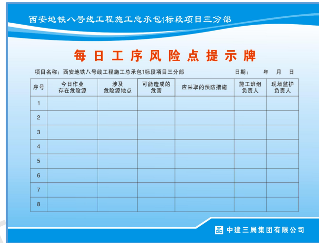
图8-91 每日工序风险点提示牌
