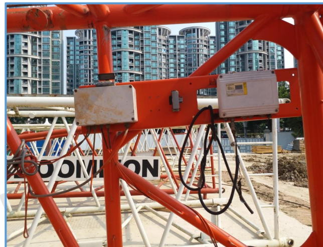
图6-147 履带吊数据线无破损、断裂
