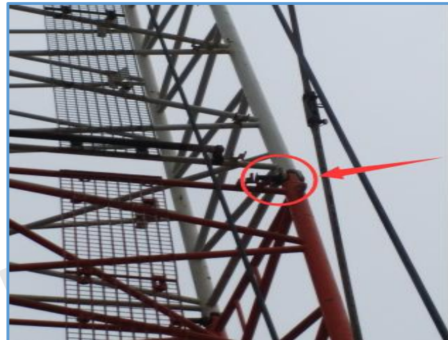
图6-139 履带吊臂架连接销保险销完好
