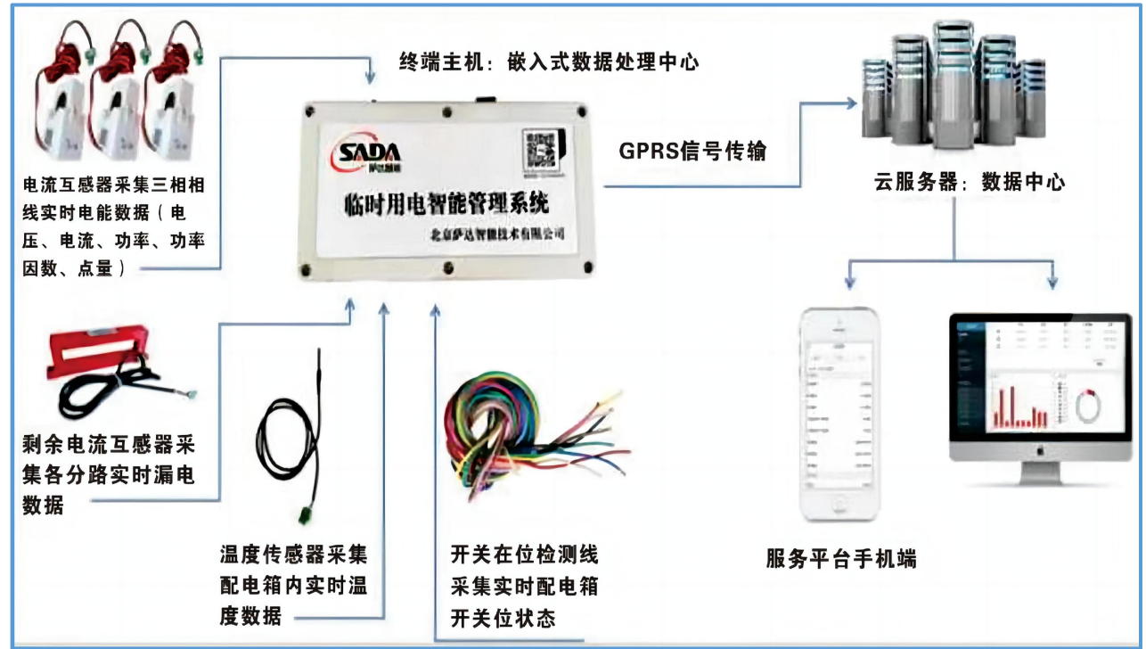
图9-63 临时用电监测系统图
