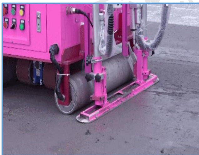
图9-78 混凝土整平机器人（3）
