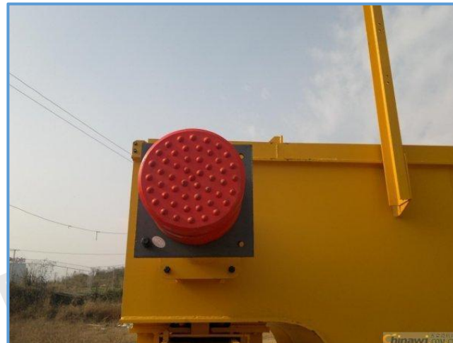
图6-154 龙门吊缓冲装置
