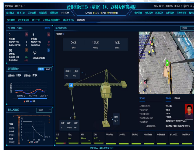
图9-47 塔吊安全监测
