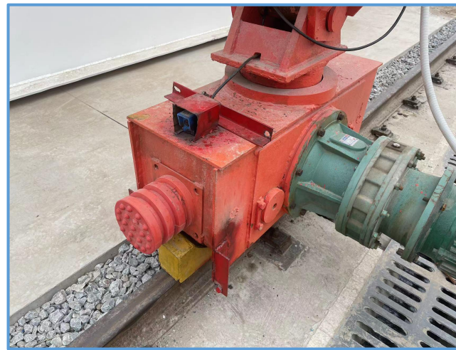
图6-156 龙门吊抗风防滑装置
