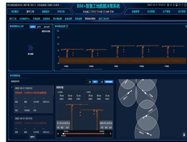
图9-48 群塔安全监测
