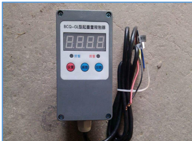
图6-152 龙门吊起重量限位器
