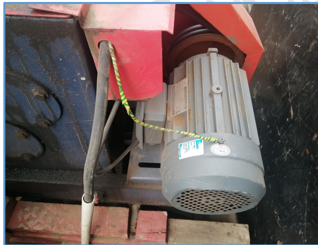
图5-28 用电设备金属外壳接零保护
