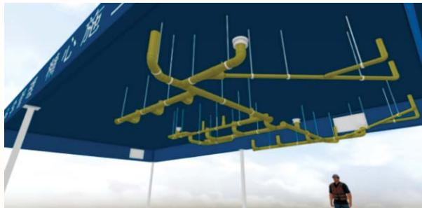
BIM排水管道模型示意图
