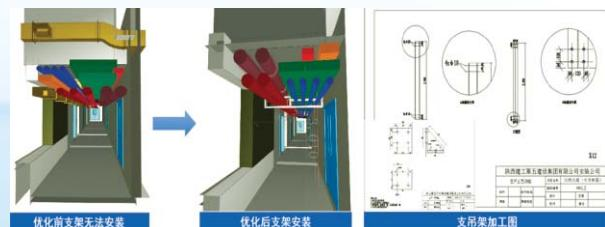
图7 确定支吊架形式
