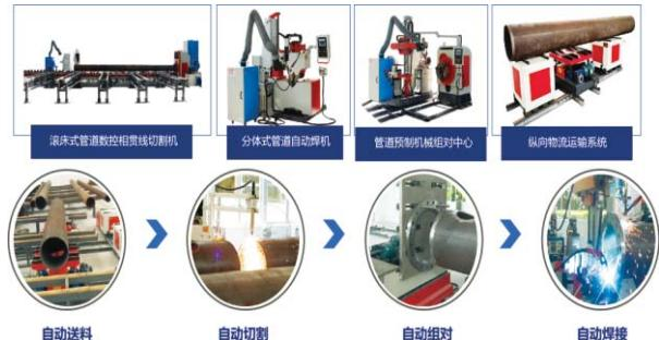
图11 工业化生产设备及生产流程
