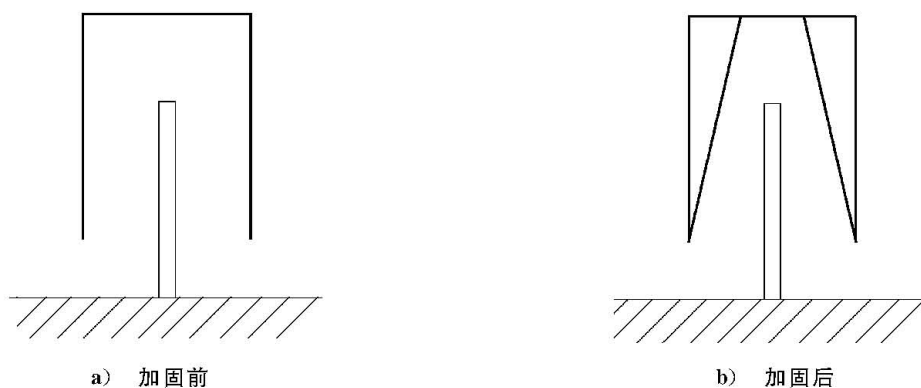
图 16 中心吊式主框架加固示意图
