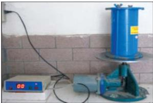
图9 振动离析率检测
