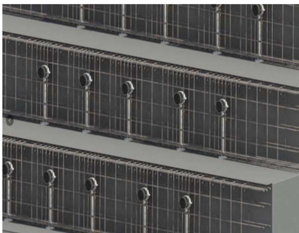
图10 陕西奥体中心座椅通风口施工工艺BIM模型
