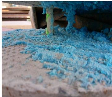
对连接件部位和无连接件部位分别取样2组进行检测，试件为直径330mm，对所取芯样进行**墙板保温相对位置**的检测以及连接件周围混凝土的**密实**情况检查。
