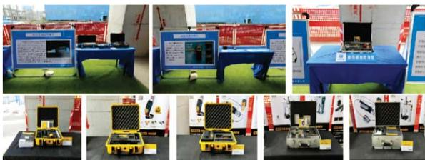
项目现场应用“四小智”实测实量、5G+智能巡检眼镜、智能混凝土回弹仪、混凝土保护层厚度测定仪、油漆厚度测定仪等智能小型器具40余项，实现人、机、料、法、环等各要素的精细化管理，助力项目提质增效，打造地区智慧建造应用标杆项目。
