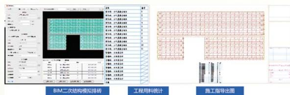
通过BIM技术对二次结构阶段进行深化设计，可实现预留洞口、精确排砖等深化应用，确保施工过程中供料及时、降低了二次搬运及现场加工量，提升成品质量。
