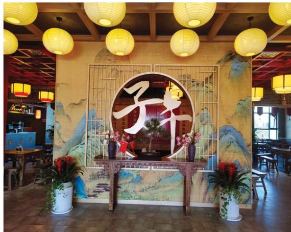
固定，视觉效果好，大大缩短了工期，降低了成本。室内立柱采用红色铝扣板装饰，不用喷漆，达到了节能环保效果。墙壁也是用装饰板拼装，不用抹灰，卫生、耐火、施工速度快，质量好。大厅和包间的浮雕、门上的花纹，都是提前做好定型图案，现场直接安装，大大节省了时间。墙上的壁画，要体现唐宫宴会的特色，有飞天、古筝表演、反弹琵琶、芦笙吹奏等，图案定稿后，用机器直接打印，然后像壁纸一样装饰于墙面，既古朴又艳丽，实现了高效快捷的目标。
