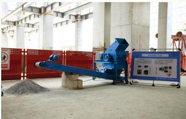
项目以废旧砌块粉碎再利用为创新点，结合施工后期装饰装修阶段，需要大量的轻集料混凝土回填的实际情况，通过广泛调研、研究分析，在现有技术的基础上创新提出了“废旧加气块再生轻集料混凝土技术”，最大程度地降低能耗，减少浪费，避免对环境的大规模污染，推进建筑垃圾减量化，实现再生资源高效利用。
