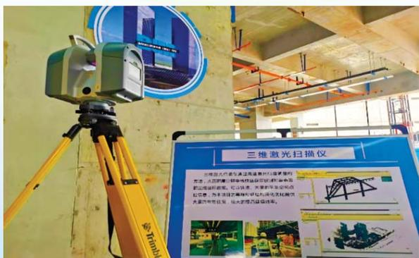
摄像头，监控室与手机端同时操作，对现场进行实时无死角监控。三维激光扫描仪对现场已完成实体进行扫描后建立点云模型，逆向建模分析结构实体偏差，可以快速、大量采集空间点位信息，为项目幕墙和钢结构深化提供有效数据。
