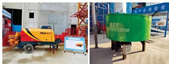
A8砂浆机器人、混凝土自动搅拌罐、专利收尘技术与螺旋输送等技术，相比传统人力施工和干混砂浆成套设备施工，具有高效筛砂、搅拌、运输、喷涂的特点，全面实现机械化运输、搅拌、泵送全程密封运作，可有效除尘降噪，轻松满足砂浆施工的国家环保标准。
