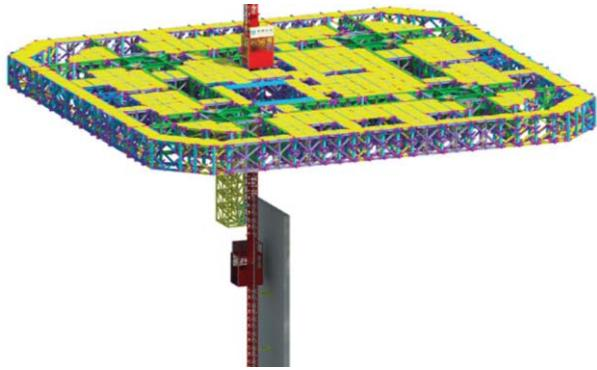
图8 施工电梯下挂格构柱BIM模型图
