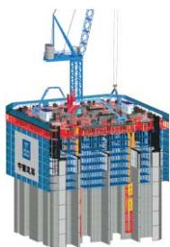
图4 智能化顶升平台BIM模型图
