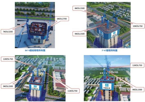
图9、10、11、12动臂塔吊选型
