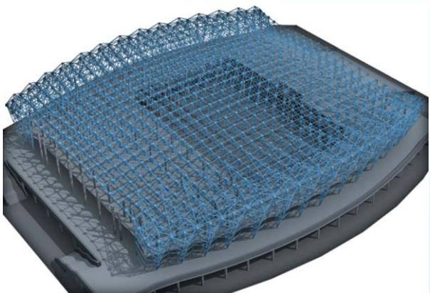
图4 网架BIM模型示意图
