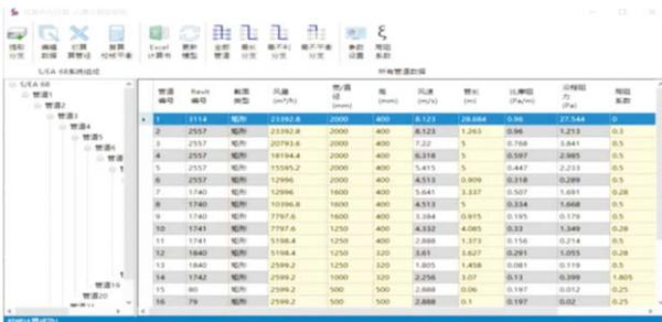
图7 风管水力计算界面
