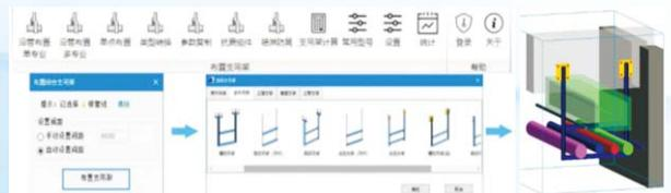
图12 一键布置支吊架
