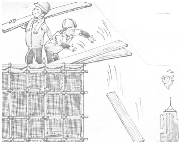
（3）高处作业暂时不用的工具，应装入工具袋，随用随拿。用不着的工具和拆下的材料应采用系绳溜放到地面，不得向下抛掷，应及时清理运送到指定的地点。
