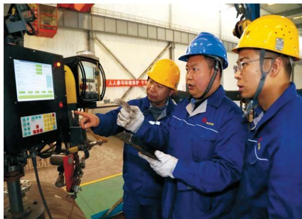
朱瑞峰在延长榆神项目50万吨年乙醇装置羰基化反应器制作时向徒弟讲解采用马鞍形埋弧焊接管角工艺焊接时注意事项
