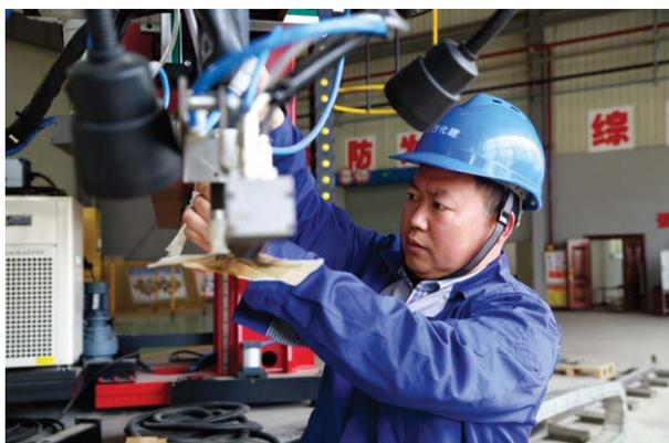
目低压反应水冷器（换热器）的焊接任务交到朱瑞锋的手上。这项施工最大的难点在于4040个内孔对接焊缝接头，要在直径只有2厘米的管子深孔内进行焊接，焊接过程中看不见焊缝熔池，焊接能否合格完全取决于预定的工艺参数。这类材质在焊接过程中还极易氧化，需要增加工装进行保护。这对朱瑞锋团队来说，无疑是一次前所未有的考验。为确保焊接一次达标，朱瑞锋连续几天跑遍省内所有的焊机厂家，到处向专家请教，办公室里桌子、地上都堆满了书籍，铺满了稿纸。为了求证一个工法，他半夜跑到工地，一头扎进现场试验中，反复调试焊接电流、钨极伸出长度、焊缝间隙、机头转速等参数，终于摸索出一套最佳焊接规范，并研制出随机保护工装将其推广到班组，最终试压无一泄漏，4040个内孔对接焊缝全部合格，受到甲方的高度赞扬，同时他研制的《一种内孔焊保护工装》也获得了国家实用新型专利，同时总结完成的《内孔焊式固定管板换热器施工工法》被中国化工施工企业协会评为工法。多年来，朱瑞锋先后参与了二
