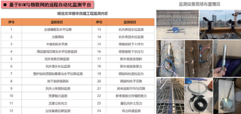
图8 施工监测内容与施工设备
