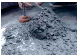
混凝土泌水、离析，施工时私自加水
